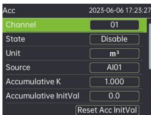
Fig. 26 – Interfaccia configurazione totalizzazione
