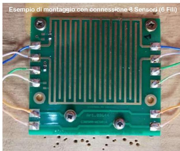
Esempio di montaggio con connessione 3 Sensori (6 Fili)
