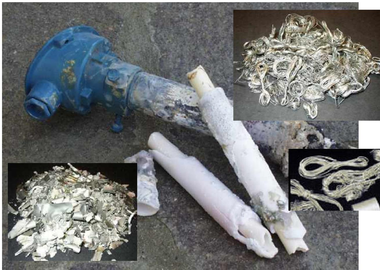
In molti dispositivi tecnici, come alcune tipologie di TERMOCOPPIE tipici nei forni per alta temperatura per la ceramica o il vetro ma non solo, sono contenuti metalli preziosi come ad esempio il PLATINO in sottili filamenti, ed anche quando i sensori si rompono e non funzionano più, questi metalli mantengono un valore residuo importante che noi possiamo recuperare per produrre nuovi sensori una volta opportunamente lavorati.
