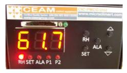
Per l'impostazione dell'allarme locale premere il tasto ALA e poi agire sui tasti freccia per ottenere il valore desiderato, l'usita fisica ON-OFF dell'allarme è disponibile sul connettore posto sul retro del modulo.
