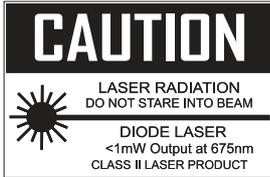
Attenzione: Lo strumento è dotato di sorgente Laser Classe II @ 675 nm
