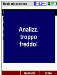
Con il NOVAcompact in queste condizioni non è possibile attivare alcuna funzione e l'analizzatore non può essere utilizzato. Il punto zero non inizierà finché la temperatura dello strumento non ha raggiunto un valore accettabile e consentito tra +5°C and +45°C.
