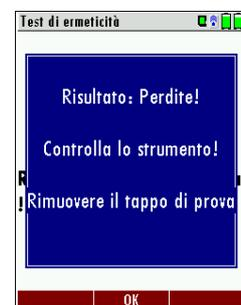
Se, alla fine dei controlli, viene accertato che non ci sono perdite nell'unità di prelievo esterna, l'analizzatore **NOVAcompact** deve essere inviato o portato presso il nostro centro di assistenza tecnica.
